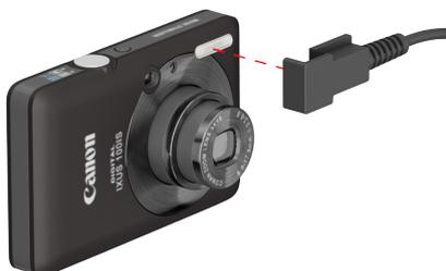
12 Conectando o Cabo Fotosensor para câmeras compactas ao flash IDbio.
